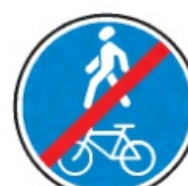
4.5.3 Конец пешеходной и велосипедной дорожки с совмещенным движением (конец велопешеходной дорожки с совмещенным движением)
